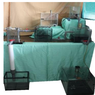
Gambar 1 Purwarupa Instalasi Pengolahan Limbah
