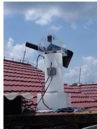
Gambar 5 Hasil perancangan sunphotometer [6]
